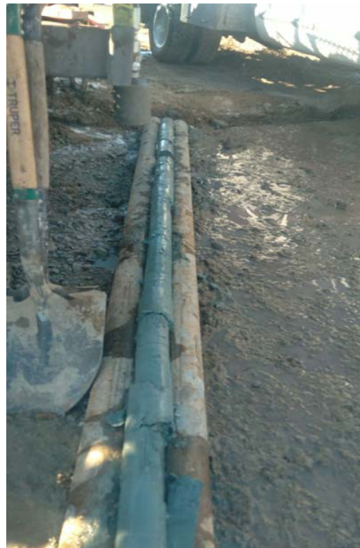
Abbildung 1 und 2 – Fotos von Bohrkernmaterial aus Bohrloch Nr. 1. Derzeit ist das Loch rund 227 Fuß (69 m) tief, es wird aber weitergebohrt.
