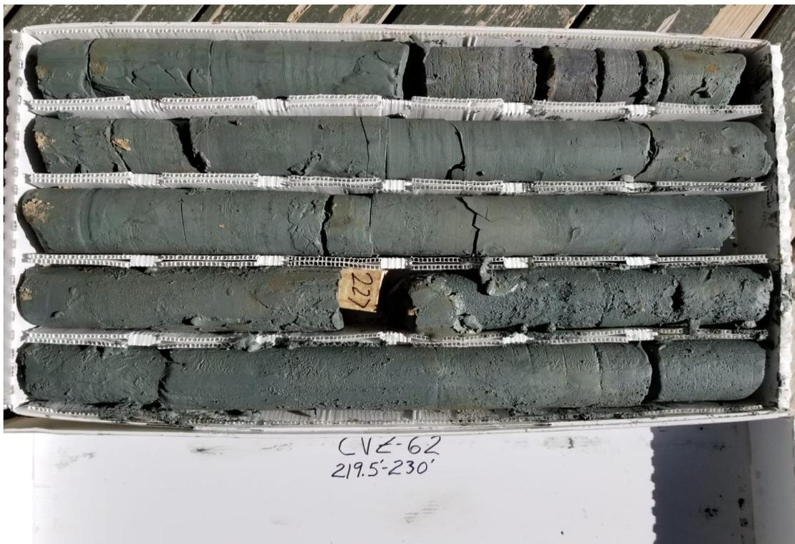
**Abbildung 1. Kernfotografien von blauen Tonsteinverbänden in Bohrloch CVZ-62 zwischen 219,5 Fuß und 230 Fuß (67 m bis 70 m).**
