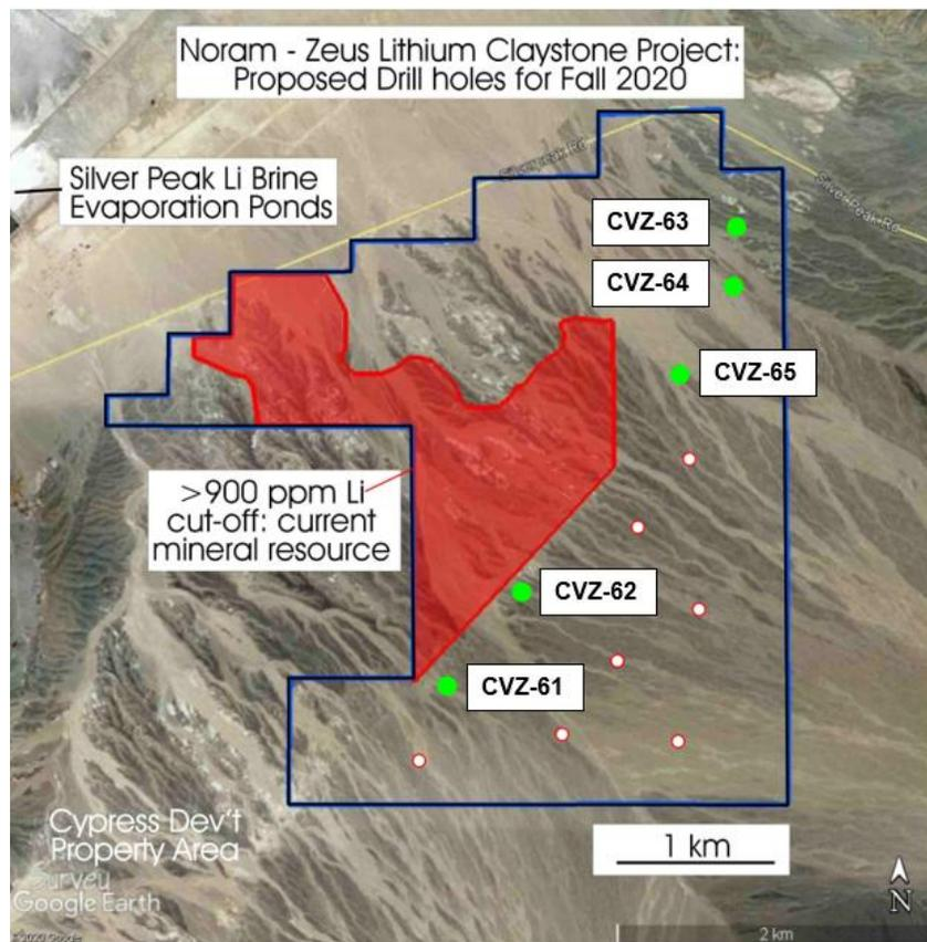
Abbildung 1. Karte des Konzessionsgebiets Zeus mit Kennzeichnung a) der Lage der aktuellen angedeuteten und vermuteten Ressourcen mit einem Mindestergehalt von >900 ppm Li; b) der Lage der bisherigen Bohrstandorte der Phase V des Programms von 2020, die bereits abgeschlossen oder noch in Arbeit sind (in Grün gekennzeichnet). Geplante Bohrstandorte, an denen noch keine Exploration stattgefunden hat, sind in Weiß gekennzeichnet.
